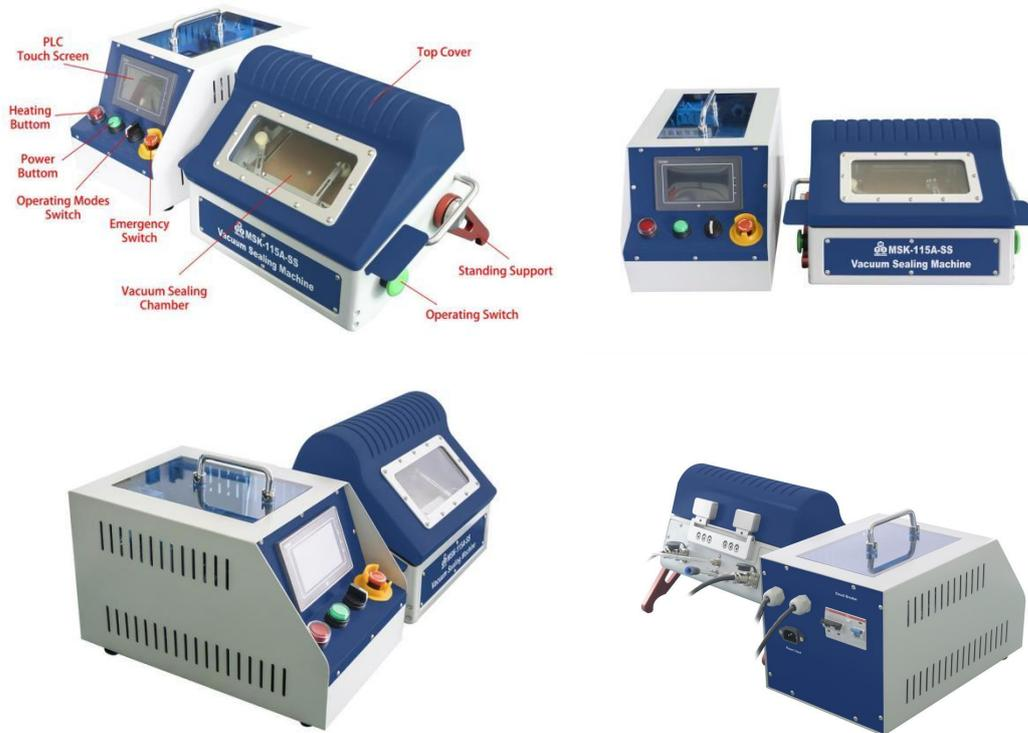
MSK-115A-SS 是一个可通过过渡舱内径 $\geq 320\text{mm}$  的小型软包电池真空封口机，可实现软包电池的顶侧封、惰性气体预清洗，真空静置、真空预封、真空二次封，电池最大尺寸为  $L100 \times W100 \times H12$  (mm)。
